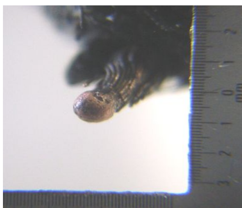
電源コード断線箇所の電気痕の拡大
