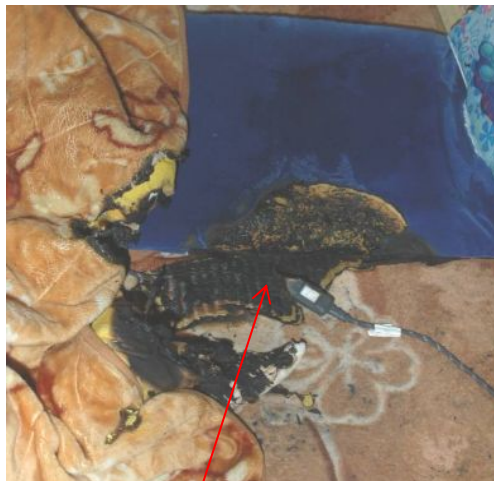
電源コード断線箇所
