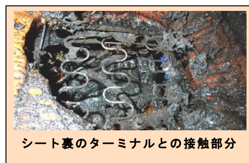
セカンドシート下に設置されたバッテリー
