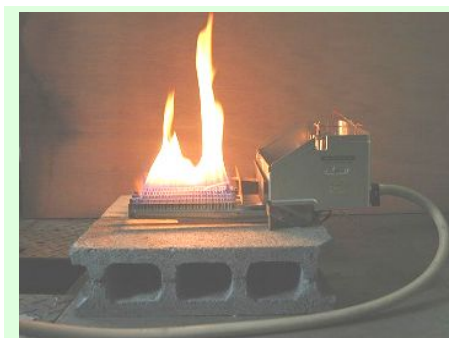
事故品のバーナーを使用している燃焼実験の状況
