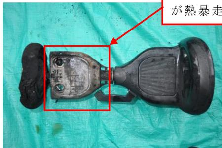
内蔵されているリチウムイオン電池が熱暴走を起こし出火した状況です。
