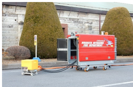
油圧駆動による水中ポンプ (50kg) に 150mm を ホース装着した状態
