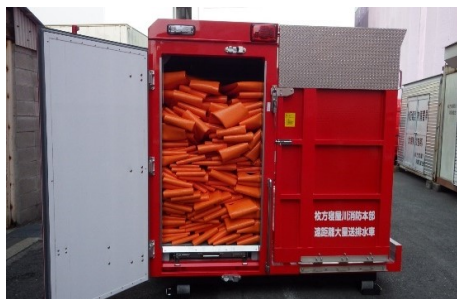
150mm ホース収納庫 (150mm ホース 1 km 分積載可能)
