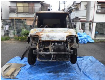
エンジンルームが焼損
