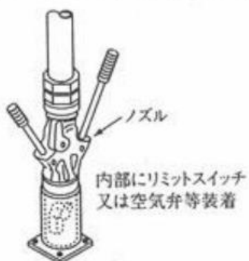
図4-2-2 ノズル格納装置による誤発進を防止する方法
