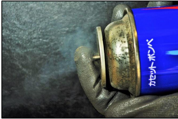
写真4 噴射口を指で塞ぎ押し込む状況
