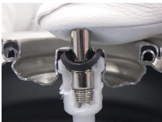
写真7 ステム押し込み時
