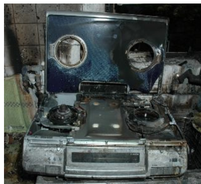
ガラストップガスコンロの天板（右側）が割れている。
