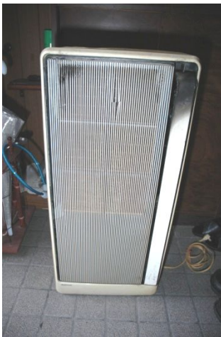
焼損した ナショナルエアコン CW-165DS
